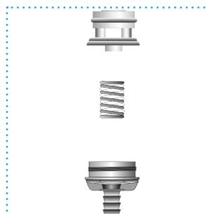
Limpiar la válvula, el muelle y el cuerpo del conector si necesario
