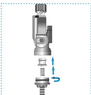
Volver a introducir la válvula en el conector, el muelle y por fin el terminal
