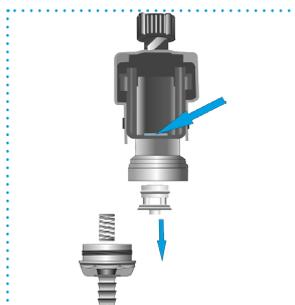
Ejercer una presión sobre la válvula por la parte superior
